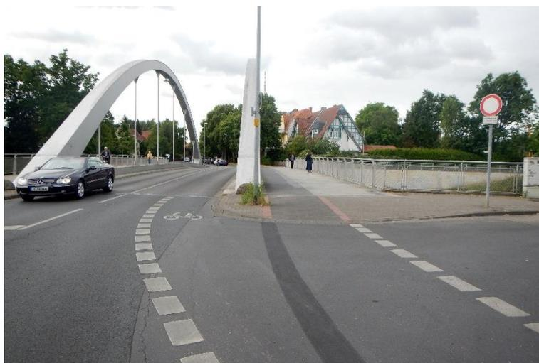
Abb. 5-9: Überleitung auf Fahrbahn (duale Führung) oder den nicht benutzungspflichtigen baulichen Radweg (Hannover)
