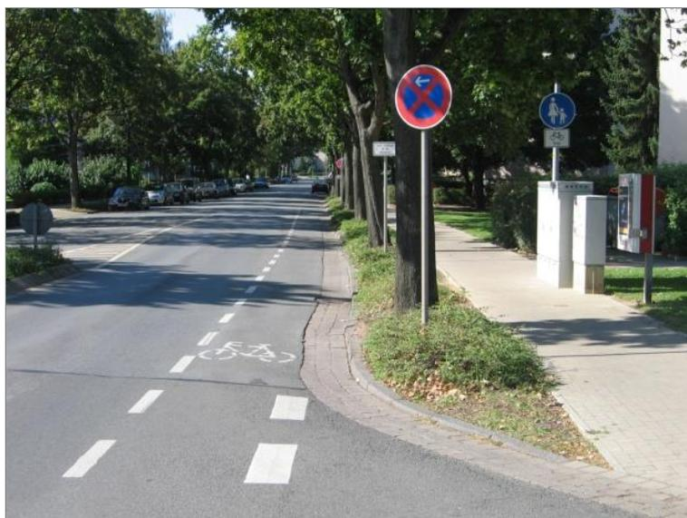
Abb. 5-13: Kombination von Schutzstreifen mit Gehweg, Radverkehr frei (Hameln)
