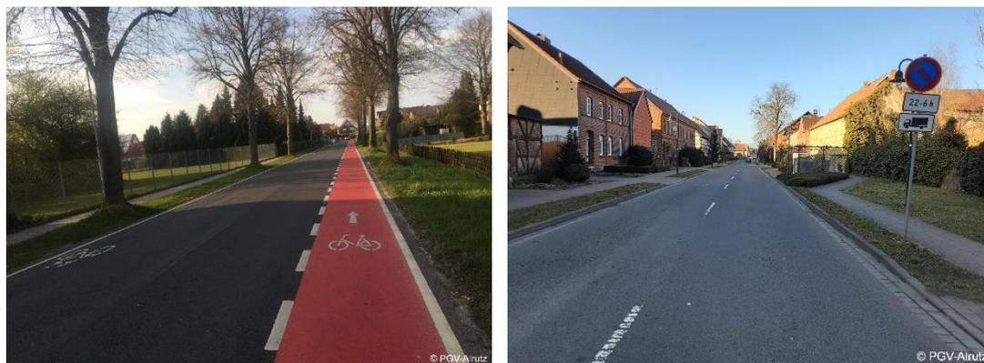
Abb. 5-26: Links: Beispiel für gemeinsamen Einsatz eines Schutzstreifens und einer gegenüber liegenden Piktogrammreihe auf der Fahrbahn (Harenberg, Region Hannover); rechts: Beispiel zur Anwendung in Haldensleben (Lange Straße, Uthmöden)
