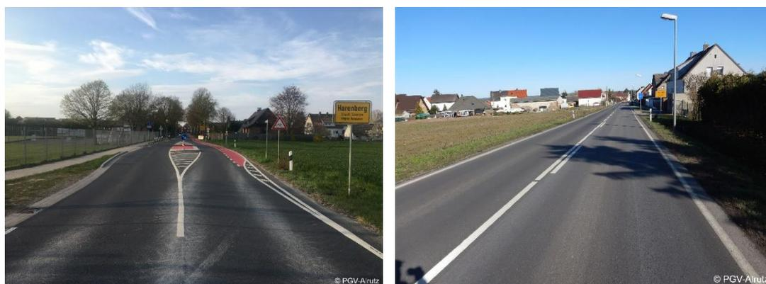
Abb. 5-29: Links: Beispiel zur Gestaltung eines Ortseingangs mit Überführung des Radverkehrs von einseitiger Führung im Seitenraum außerorts in die richtungstreue Führung innerorts (Harenberg, Region Hannover); rechts: Beispiel zur Anwendung in Haldensleben (Bodendorfer Straße, Süplingen)
