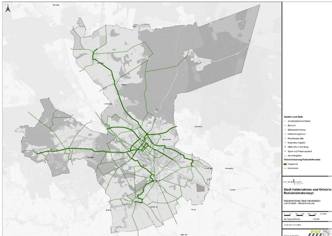
Abb. 4-2: Kommunales Radverkehrsnetz Haldensleben, inkl. Hierarchisierung in Haupt- und Nebenrouten (Stand 16.05.2022)
